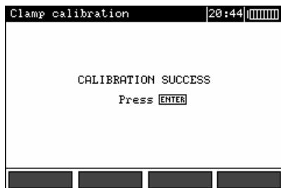
Přístroj vypočítá korekční činitel připojené klešťové sondy. Korekční činitel se uloží do paměti a zůstane v ní uložen i po vypnutí přístroje až do úspěšného ukončení další kalibrace klešťové sondy.
